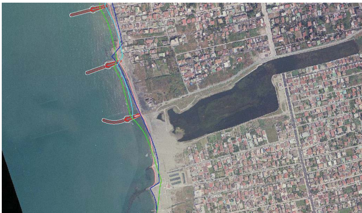
Figura 56 - Rappresentazione della linea di riva attuale (linea rosa), dell'evoluzione prevista a 10 anni nella condizione A0 (linea blu), A1 e A2 senza ripascimento (linea azzurra) e A1 e A2 con ripascimento (linea verde).
